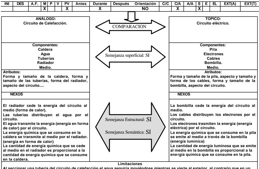
Al seccionar una tubería del circuito de calefacción el agua seguiría moviéndose mientras se vierte al exterior, al contrario que en un circuito eléctrico que al cortar el cable la electricidad deja de circular.
