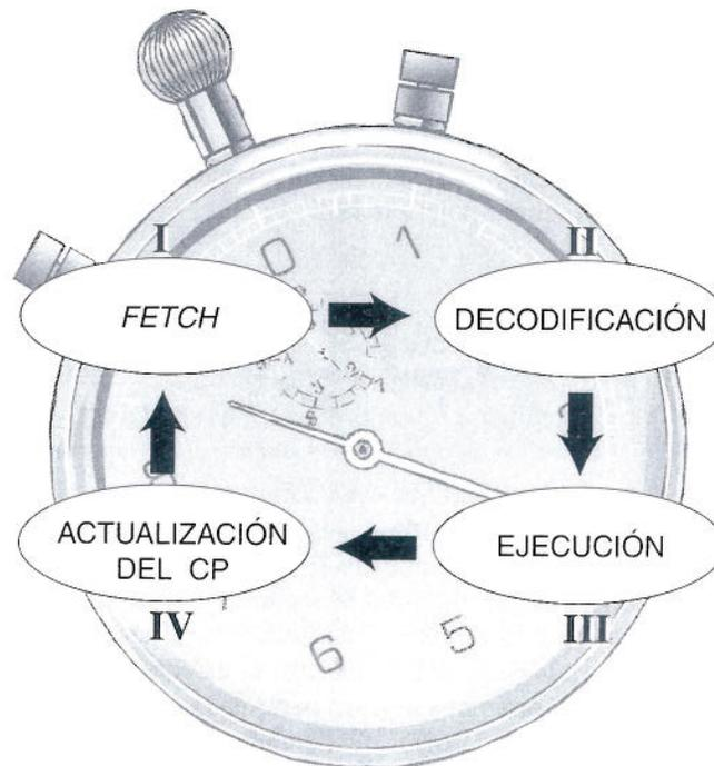
**Figura 23** Modelo digital de la unidad de control
